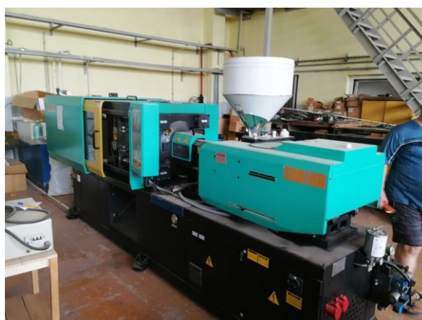
Машина инженерно-литьевая LOG 130 A8 с установленным стандартным шнеком и цилиндром тип В, 2016 г.в
