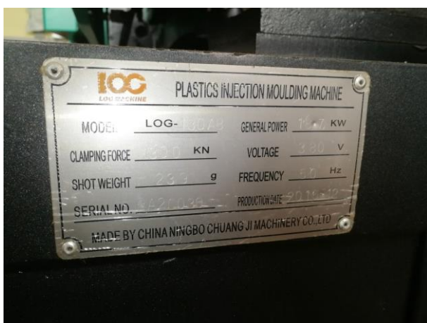
Машина инженерно-литьевая LOG 130 A8 с установленным стандартным шнеком и цилиндром тип В, 2016 г.в
